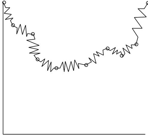
Figure 1: Système masses-ressorts
