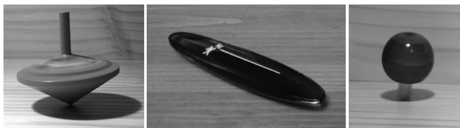
FIG. 4: Exemples des corps solides avec un point fixe. Gauche : Toupie. Centre : Anagyre. Droite : Tippe-top.
