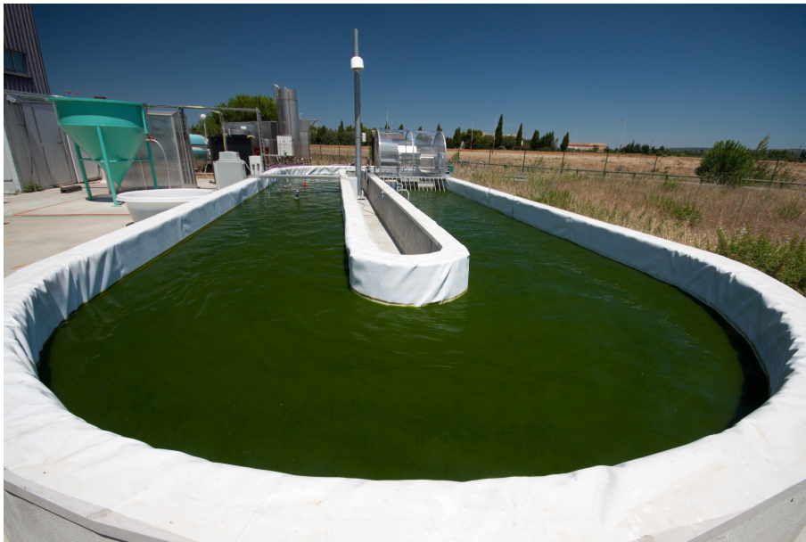
FIG. 2: Un bassin pour la culture des microalgues avec la roue à aubes qui force l’agitation - Image INRA.
