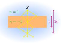
⇒ La réfraction négative à l'interface métamatériau/diélectrique pourrait permettre de concevoir des lentilles parfaites, des pièges à photons...
