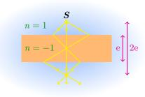
⇒ La réfraction négative à l'interface métamatériau/diélectrique pourrait permettre de concevoir des lentilles parfaites, des pièges à photons...
