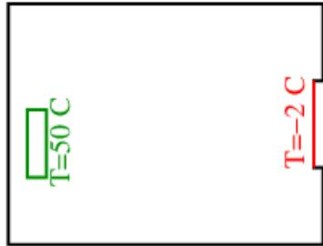
Un radiateur chauffe une pièce d'habitation, supposée remplie d'air. Le radiateur est maintenu à  $50^\circ\text{C}$ , une fenêtre en verre située à l'autre extrémité de la pièce est à une température de  $-2^\circ\text{C}$ , et nous envisagerons différentes hypothèses en ce qui concerne les murs de la pièce.
