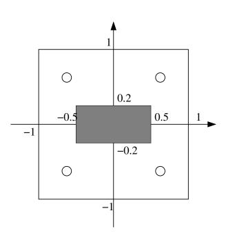
On considère un four de forme rectangulaire, comportant des résistances. On se propose de chercher les valeurs à donner aux résistances de sorte que la température dans une partie du four soit proche d'une valeur fixée à l'avance.
