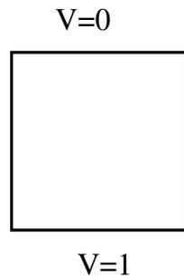
On applique une différence de potentiel entre les bords (hauts et bas sur la figure) d'une plaque carrée, les bords latéraux restant libres (pas de fuite de courant). Cette plaque est composée de deux matériaux, le rapport de résistivité étant de 1000. On prendra  $\rho_0 = 1000 \Omega \text{ cm}$  et  $\rho_1 = 1 \Omega \text{ cm}$ .
